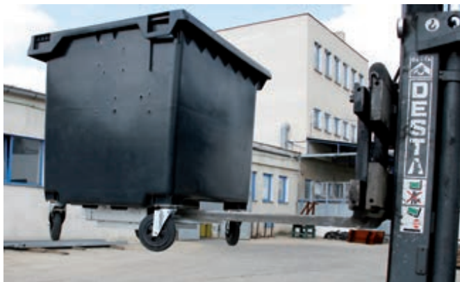
Adaptér pre manipuláciu vysokozdvížným vozíkom.
